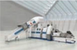
**Starlinger** presentó recientemente la máquina recoSTAR universal que está equipada con una robusta desmenuzadora de un solo eje, encima de la extrusora. De este modo no constituyen ningún problema tampoco las láminas y materiales difíciles de desmenuzar tales como cintas, fibras y tortas de arranque.
