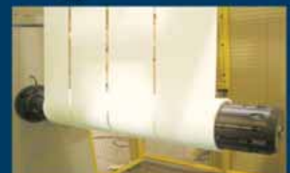
Opciones de embobinado diferencial para embobinado de varias laminas en un solo eje.
