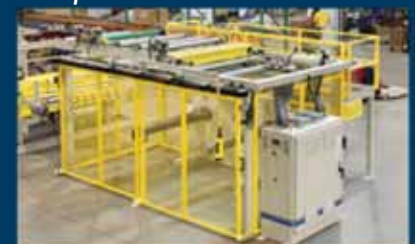
Diferentes opciones de embobinado disponibles incluyendo cantiliver (en la foto), marco, carrete y completamente automática.
