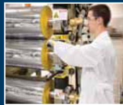
Posicionamiento de altura del punto de contacto de los rodillos de trinquete integral
