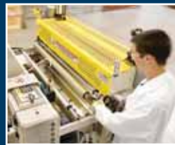
Aplicador universal de recubrimientos anti-estática para aplicaciones en la cara superior, inferior o ambas caras
